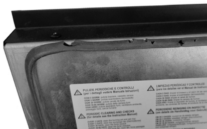
Fig. 24 - Junta deteriorada
