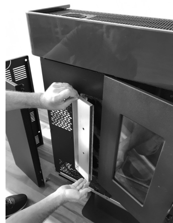
Fig. 36 - Remoção do painel de inspeção
