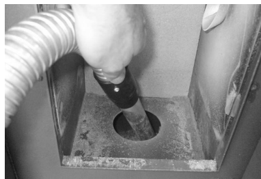
Fig. 32 - Limpeza do compartimento do braseiro
